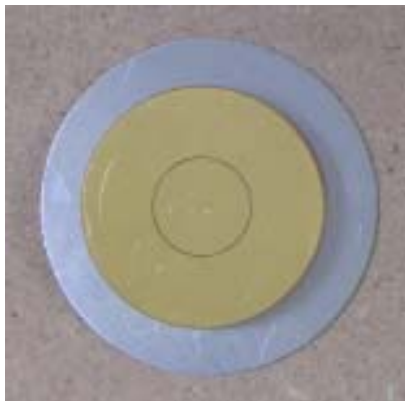
Disque d'Al6061-T6 instrumenté avec un capteur quartz
