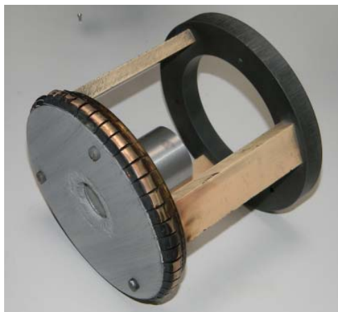
Disque d'Al6061-T6 instrumenté avec un capteur quartz
